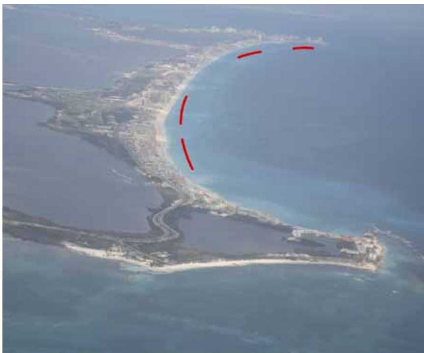
Các đường màu đỏ chỉ vị trí đê phá sóng được xây dựng bằng công nghệ Geotube® tại bờ biển Cancun's. Bằng cách làm thay đổi mô hình sóng, các đê phá sóng này giúp bãi biển được bồi lắng, và bảo vệ bờ biển tránh xói lở trong tương lai.
