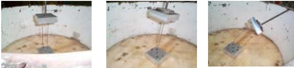
Hình 4. Sự phá hoại của nhóm một hàng cọc mô phỏng móng cầu Showa
