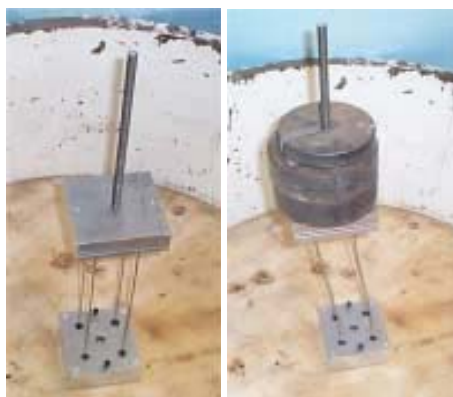
Hình 4. Sự phá hoại của nhóm một hàng cọc mô phỏng móng cầu Showa
