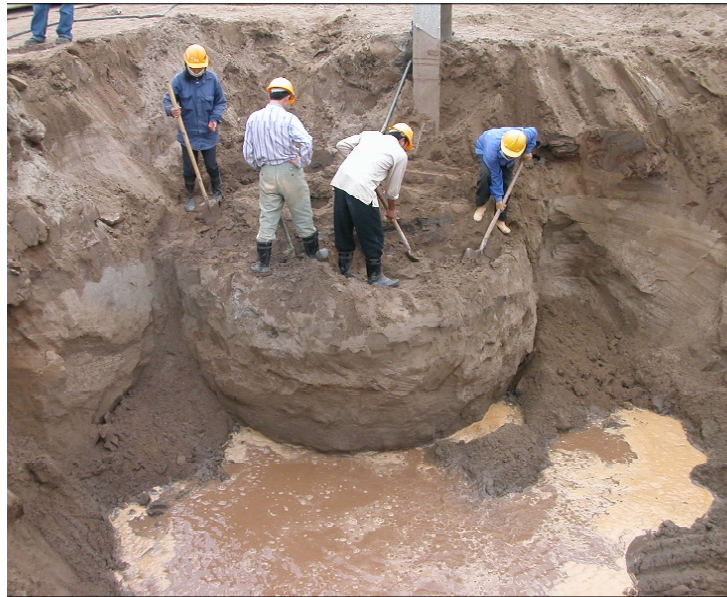
Thí nghiệm đào trực tiếp đo đặc kích thước khối phun
