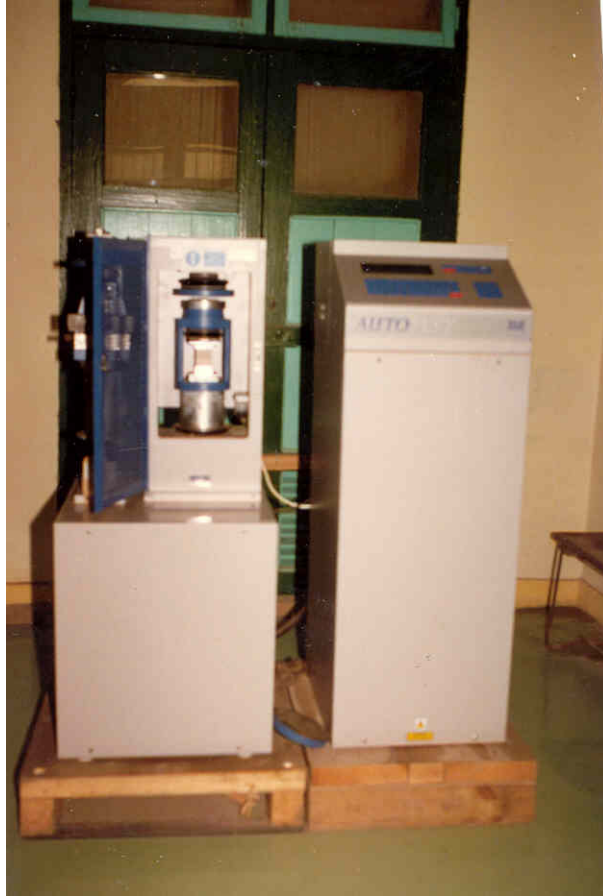
Hình 4.1 Kiểm tra cường độ nén của vữa tại phòng thí nghiệm
