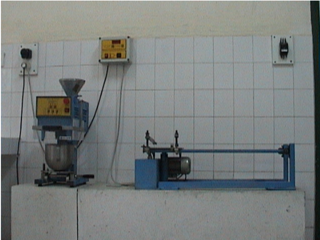
Hình 12.1. Máy trộn vữa xi măng và bàn dần đúc mẫu vữa xi măng
