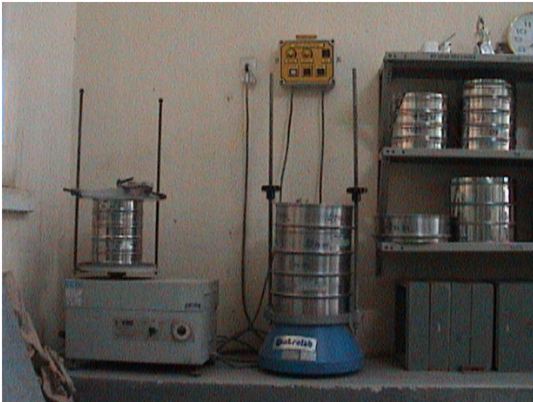
Hình 12.2. Bộ sàng và máy lắc sàng xác định thành phần hạt của cốt liệu
