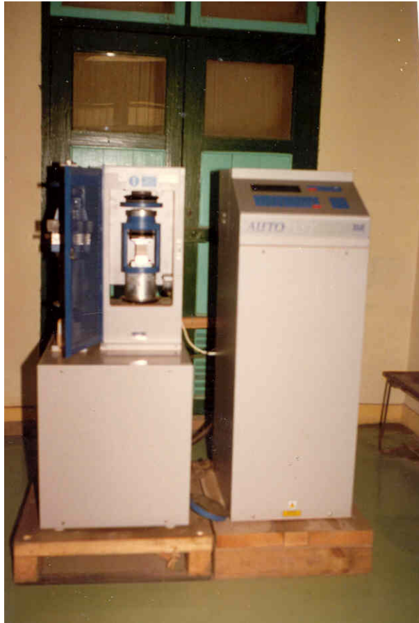
Hình 12.8. Kiểm tra cường độ nén của vữa tại phòng thí nghiệm
