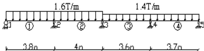
Dầm có tiết diện  $0.2\text{m} \times 0.3\text{m}$ ;  $E = 2.5e6 \text{ T/m}^2$  hệ số Poisson 0.25
