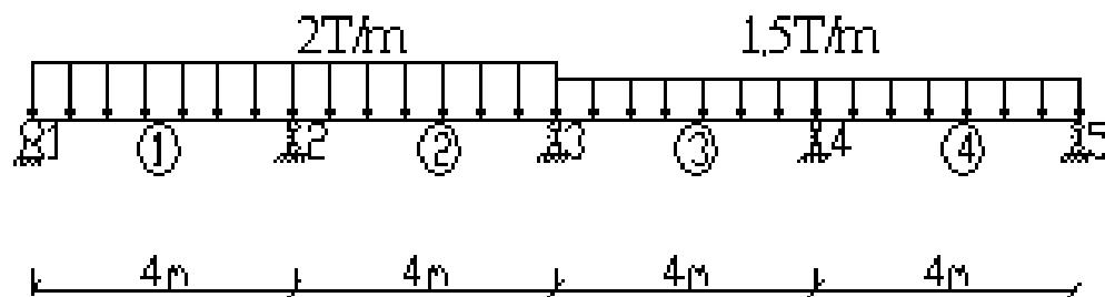
Dầm có kích thước  $0.2\text{m} \times 0.3\text{m}$ ;  $E = 2.5\text{E}6 \text{ T/m}^2$  hệ số poisson = 0.25
